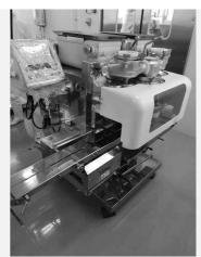
TK-BK-MX21091001 メーカ 関東混合機工業㈱ 商品番号 商品名 60/30兼用縦型ミキサー 型式 HP-60 製造年月日 製造番号 119783 2003年10月 寸法 W670×D720×H1,383(カタログ値) 電力・Hz 3相200V 1.5kw 昇降モーター0.1k ガス種 備考・その 付属品:60L(ステンレスボウル×1、フック×1)、兼用30L(ス 他条件 テンレスボウル×1、フック×1)
