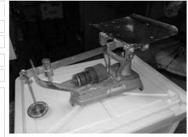
商品番号 JA-BK-CT20090201 メーカ 富士島工機㈱ 商品名 水平切スライサー 型式 HT-4 製造番号 31 製造年月日 90.05 寸法 W1,380×D850×H1,320(176kg) 電力・Hz 3相200V 250w 50/60Hz ガス種 借考・その 他条件 仕様:商品カット寸 高さ5~90mm、幅360mmまで 1~5段 切り
