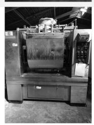
TK-BK-MX21121504 メーカ (株)フジサワ 商品番号 商品名 3袋 横型ミキサー 型式 FH-3 製造番号 製造年月日 1991.4 3551 寸法 W2,000×D1,400×H1,900(H3,900サイロ含む) 電力・Hz 3相200V 12.5kw 50Hz ガス種 備考・その サイロ付(H2.000) 他条件
