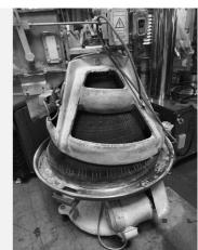
商品番号 TK-BK-ZL19051101 メーカ 万食品機械㈱ 商品名 万式成型機 YSH547-112 製造番号 対法 電力・Hz 3相200V 0.4kw ガス種 備考・その 他条件
