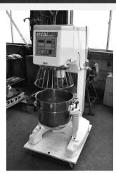
TK-BK-MX18081701 メーカ (株)藤澤製作所(現フジサワ) 商品番号 商品名 5袋用横型ミキサー 型式 FH524 製造番号 5228 製造年月日 昭和58年12月 寸法 W1,970 × D1,180 × H2,210 電力・Hz ガス種 備考・その ジャケットに穴あり 他条件
