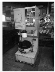
TK-BK-DV21012501 メーカ (株)コトブキベーキングマシン 商品番号 商品名 半自動分割丸目機 型式 **DR30** 製造番号 17124 製造年月日 2007年7月 寸法 W650 × D800 × H1,350 3相200V 0.75kw 2.1A 電力・Hz ガス種 60Hz 備考・その 30分割 丸目板2枚(1枚キズ有) 他条件
