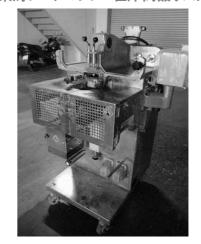
商品名 ミキサー 型式 NAM-50 製造番号 ESAQ018 寸法 W750 × D800 × H1,560 電力·Hz 備考・その 付属品:ボール×1、ホイッパー×1、ビーター×1 他条件
