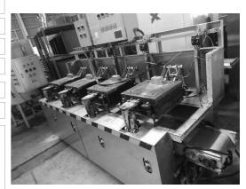
商品番号 SA-BK-ZL21031103 メーカ セイカイ堂 商品名 テンパリング機能付ケトル 型式 製造番号 11247 製造年月日 H3.9 寸法 W1,150 × D1,100 × H1,620 電力・Hz 200V 2.4kw 60Hz ガス種 備考・その 100L 他条件
