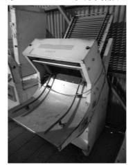
SA-BK-PT21101208 メーカ (株)鎌田機械製作所 商品番号 商品名 リバースシート 型式 KM-3 製造番号 製造年月日 56年 708 寸法 W2,900 × D900 × H1,200 電力・Hz 3相200V ガス種 備考・その フットスイッチ有 ローラ0.3~32 他条件
