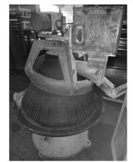
TK-BK-DV20041603 メーカ レオン自動機㈱ 商品番号 商品名 フリーデバイダーVS 型式 VX011 製造番号 製造年月日 2009.3月 00159 寸法 W1,280 × D670 × H1,580 3相200V 4.3A 60Hz 電力·Hz ガス種 備考・その ベルトコンベア1500×360 他条件
