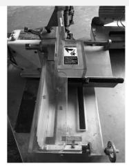
SA-BK-OV22091522 メーカ 東京コトブキインダストリー 商品番号 商品名 キャメル オーブン 型式 KOCG6044 製造番号 4693 製造年月日 30.7 寸法  $W1,320 \times D1,600 \times H1,950$ 電力・Hz 200V ガス種 備考・その 縦差4枚4段、炉床:石板 蒸気あり、付属品:引掛棒 他条件
