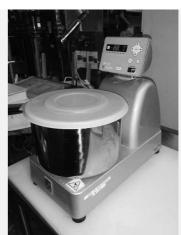
TK-BK-MO21021202 メーカ (株)品川工業所 商品番号 商品名 餅・団子ミキサー 型式 MM-41 製造番号 540359 製造年月日 寸法 W410 × D750 × H640 電力・Hz ガス種 3相200V 60Hz 備考・その 羽根大×1、フタ有り 他条件
