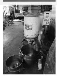
TK-BK-HO21083102 メーカ 共立プラント工業(株) 商品番号 商品名 ドゥコンディショナー 型式 DH-32F2 製造番号 RA-72039N35 製造年月日 2003年9月 寸法  $W770 \times D1,190 \times H1,950$ 電力・Hz 3相200V 1.7kw 60Hz ガス種 R22 備考・その 1室32枚 他条件
