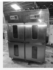
TK-BK-HO21090102 メーカ 共立プラント工業(株) 商品番号 商品名 パンジャ ホイロ/ドゥコンディショナー 型式 DPH-6424 製造番号 製造年月日 2000年3月25 KAW16003N36 寸法 W1,490 × D1,200 × H1,950 電力·Hz 3相200V 2.7kw 60Hz ガス種 R22(冷媒ガ 備考・その 左室ドゥコンディショナー32枚差 右室ホイロ32枚差し 計64 他条件 枚差
