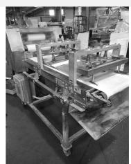
TK-BK-DV20041601 メーカ (株)オシキリ 商品番号 商品名 2口分割機 型式 DQE 製造番号 211173 製造年月日 2002.3月 寸法 W1,100 × D800 × H1,570 電力•Hz 3相200V 60Hz ガス種 備考・その (ホームライン) 他条件
