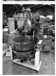
商品番号 TK-BK-AN22071103 メーカ ㈱飯田製作所 商品名 1袋用蒸練機 型式 1TN 製造番号 01600158 製造年月日 平成14年製 寸法 W850 × D1,150 × H1,350 電力•Hz 3相200V ガス種 備考・その ジャケット式 他条件
