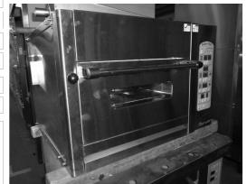
JA-BK-OV18091202 メーカ (株)フジサワ 商品番号 商品名 コンベクションオーブン 型式 MBCO-5C-B 製造番号 製造年月日 11.09.16 寸法 W940 × D870 × H1,520 電力·Hz 3相 200V 9.5kw 50/60Hz ガス種 備考・その スチーム有 フランス天板5枚 他条件
