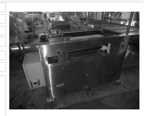
TK-BK-MX19052201 メーカ (株)フジサワ 商品番号 16袋横型ミキサー 商品名 型式 FHS-16 製造番号 98-120 製造年月日 1999年2月 寸法  $W2.630 \times D2.170 \times H2.600$ 電力・Hz 3相200V 48kw ガス種 備考・その 専用ドゥBOX 2台 他条件
