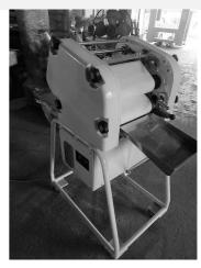
SA-BK-MR21101210 メーカ (株)オシキリ 商品番号 商品名 ワイドファインモルダー 型式 WF 製造番号 726610 製造年月日 1982 寸法  $W1,550 \times D730 \times H1,300$ 電力・Hz 3相200V 60Hz ガス種 備考・その ローラメッキ不良 樹脂ローラ傷あり・前・後 他条件
