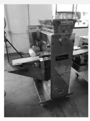
商品番号 TK-BK-RE20073105 メーカ レオン自動機(株) 商品名 手粉払い機 型式 NV191 製造番号 製造年月日 2003年8月 806 寸法  $W1,330 \times D640 \times H920$ 電力・Hz 3相200V 0.09kw 50/60Hz ガス種 備考・その ※CN120(TK-BK-RE20073101のセット品) 他条件
