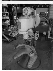
商品番号 TK-BK-MO19022101 メーカ 中井機械工業(株) 商品名 クランク式餅搗機 型式 製造番号 不明 製造年月日 不明 寸法  $W650 \times D870 \times H2,250$ 電力·Hz 3相200V 2.25kw 60Hz ガス種 備考・その レンタル専用 他条件
