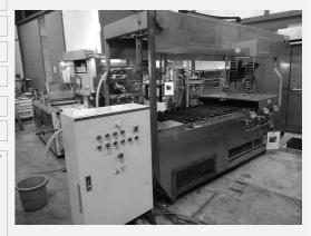
商品番号 SA-BK-ZL21031102 メーカ 三鳥産業(株) 商品名 エビ煎餅用圧延焼成機(せんべい焼き機) 型式 AAE36-4 製造番号 029 製造年月日 9-4 寸法 W3,000 × D980 × H1,800 電力・Hz 3相200V 12.3kw ガス種 備考・その 4箇所焼成 他条件
