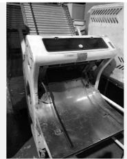
SA-BK-CT21101205 メーカ 冨士島工機(株) 商品番号 1本切スライサー 商品名 型式 EX-2 製造番号 550 製造年月日 95.6 寸法 W670 × D1,180 × H1,600 電力·Hz 3相200V 60Hz ガス種 備考・その 36枚切(8mm) 他条件
