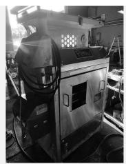
TK-BK-AN20040802 メーカ 小林京鳳堂(現㈱コバード) 商品番号 転倒式カイ式撹拌機 商品名 型式 製造番号 8728 製造年月日 6209(62年9月 寸法 W1,350 × D1,100 × H2,000 電力・Hz 3相200V 0.75kw 50Hz ガス種 LPG 備考・その 羽根 樹脂×1、木×1 他条件
