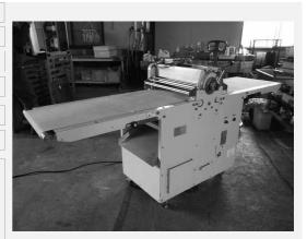
商品番号 TK-BK-PT22110801 メーカ ㈱鎌田機械製作所 商品名 リバースシート 型式 KR-16 製造番号 G1248 製造年月日 寸法 W2.230 × D660 × H1.020 雷力·Hz ガス種 備考・その 足踏みスイッチ ローラー0.5mm~15.0mm 他条件
