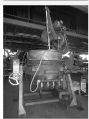
TK-BK-PT20032701 メーカ 正城機械㈱ 商品番号 商品名 パイローラー 型式 SR-B 製造番号 01007 製造年月日 寸法  $W2,260 \times D640 \times H1,130$ 電力・Hz ガス種 0.4kw 備考・その 全長番号1 他条件
