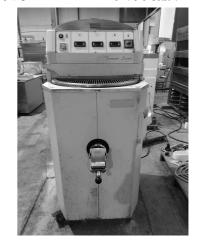
TK-BK-MX22012601 メーカ 関東混合機工業(株) 商品番号 商品名 60L縦型ミキサー 型式 HP-60 製造番号 製造年月日 98年3月 105260 寸法 W670 × D720 × H1,383 電力·Hz 3相200V 1.5kW 60Hz ガス種 備考・その
