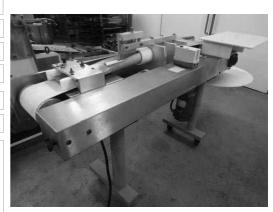
商品番号 TK-BK-PT22080401 メーカ SEEWER ROND セーバー 商品名 エコノムパイローラー 型式 SSO514 製造番号 B8A070017 製造年月日 1998年 寸法  $W2.500 \times D940 \times H1.330$ 電力・Hz 3相200V 0.75kW ガス種 備考・その テーブル収納時:850×940mm、ローラー幅:500mm、ロー 他条件 ラー間隔:0.5~30mm
