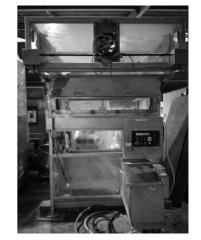
SA-BK-CT21101204 メーカ 冨士島工機(株) 商品番号 商品名 1本切スライサー 型式 EX 製造番号 製造年月日 S51.10 1118 寸法 W670 × D1,180 × H1,600 電力·Hz 3相200V 60Hz ガス種 備考・その 15枚切(21mm) 他条件
