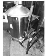
商品番号 TK-BK-DV20021201 メーカ (株)コトブキベーキングマシン 商品名 分割丸目機 型式 DR30 製造番号 製造年月日 55.11月 寸法 W600 × D730 × H1,350 電力・Hz 3P200V 1.5kw ガス種 備考・その 丸目(アルミ)板2枚(少々キズ有) 他条件
