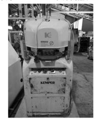
TK-BK-PT20080501 メーカ 正城機械(株) 商品番号 商品名 パイローラー 型式 PMM 製造番号 不明(013586かも知れない 製造年月日 不明 寸法 W3,060 × D860 × H1,150 電力·Hz 3相200V ガス種 備考・その 足踏みスイッチ付、接触不良有 他条件
