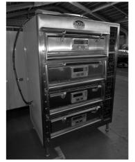
TK-BK-OV18072802 メーカ (株)久電舎 商品番号 商品名 エレクトリックオーブン 型式 MC-FIR4-3L 製造番号 製造年月日 2007年10月 6585 寸法 W1.370 × D1.500 × H1.900 電力·Hz 3相200V 21kw ガス種 備考・その フランス天板 縦4枚×3段 他条件
