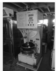
商品番号 TK-BK-ZL19080601 メーカ 新日本機械工業㈱ 現・マ システムワン 商品名 型式 SO-2 製造番号 1927? 1027?(判読困難 製造年月日 1993年12月 寸法  $W2,126 \times D1,005 \times H1,480$ 3相200V 3.5kw 60Hz 電力・Hz ガス種 備考・その エア一使用量:80L/分(0.5Mpa) 丸カップ12連型 他条件 (210×300×H25)約200枚 テフロン加工付 ※丸カップ丸 部分寸法:上径56 φ 底径50 φ 深さ22
