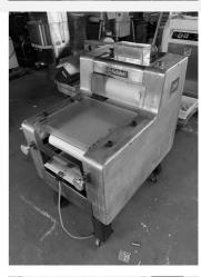
商品番号 IT-BK-DV22022501 メーカ 愛工舎製作所 商品名 食パン用分割機 オートディバイダー 型式 DIVA20 製造番号 製造年月日 寸法 幅495奥行795高さ789 電力・Hz 3相200V1. 1kw ガス種 備考・その 20分割:150g~350g 他条件
