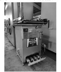
TK-BK-AN20073102 メーカ (株)遠藤機械製作所 商品番号 商品名 カイ式万能煮炊機 型式 明記なし 製造番号 製造年月日 明記なし 明記なし 寸法 W650×D1,150×H2,130(上昇時) 電力·Hz 3相200V 60Hz ガス種 備考・その 銅鍋寸法 φ 54m/m 他条件
