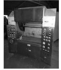
TK-BK-HO19021501 メーカ (株)コトブキベーキングマシン 商品番号 商品名 ドゥコンディショナー KDM-36S 型式 製造番号 製造年月日 31199 寸法 W900 × D1,270 × H2,200 電力·Hz 3相200V 2.7kw ガス種 備考・その 他条件
