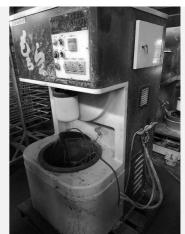
TK-BK-MO21101407 メーカ 渡辺工業(株) 商品番号 自動もちつき機(クランク式) 商品名 型式 WK-1型 製造番号 900391 製造年月日 寸法  $W900 \times D1,000 \times H1,800$ 電力·Hz 3相200V 60Hz ガス種 備考•その 他条件 ※杵先使用可
