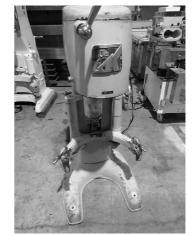
TK-BK-AN22071101 メーカ ㈱飯田製作所 商品番号 商品名 三本棒式撹拌機 型式 A101 製造番号 製造年月日 2012年10月 14112 寸法 W1,140×D850×H1,700(約) 電力·Hz 3相200V ガス種 備考・その 蒸気式 転倒式 鍋寸 $\phi$ 620m/m 他条件
