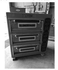
JA-BK-OV22071303 メーカ (株)七洋製作所 商品番号 商品名 BACKENオーブン 型式 BKS-F23T 製造番号 製造年月日 19-8 86784 寸法 W1,350 × D1,000 × H1,780 電力·Hz 3相200V 15.2kw ガス種 備考・その 2枚3段 他条件
