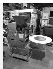
商品番号 IT-BK-ZL22072601 メーカ 関東混合機工業㈱ 商品名 ベーグル成型機 型式 KSF-300S 製造番号 (判読困難) 製造年月日 寸法 W760×D2200×H1016(カタログ値) 電力・Hz 3相200V 0.75kw(モーター容量) ガス種 備考・その 最大成型数3600個/H 基本重量137kg(カタログ値) 他条件
