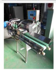
JA-BK-CT20081901 メーカ 渡辺工業(株) 商品番号 商品名 自動のし餅カッター 型式 WK-W 製造番号 831099 製造年月日 寸法 W1,080×D1,120×H1,050 (最大寸法:W1,700×D1,160×H 電力・Hz 3相200V 400w ガス種 備考・その 丸刃19枚(タテ9枚·ヨコ10枚)130 o 、カバー割れ有·使用 他条件 可、まな板ゴム1枚
