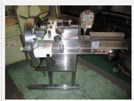
メーカ Greaf 商品番号 BK-CT12111502 商品名 1枚切スライサー 型式 S-2560 3 製造番号 1619 1 製造年月日 寸法 W370 × D540 × H360 電力·Hz 100V ガス種 備考・その のこ刃 他条件
