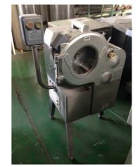
TK-BK-CT17082501 メーカ 冨士島工機(株) 商品番号 多目的スライサー 点滴装置付 商品名 型式 R-7 製造番号 製造年月日 不明 不明 寸法 W1.020 × D1.540 × H1.400 電力·Hz 3相 200V ガス種 備考・その 8mm、25mm、66.5mm カット 他条件
