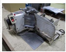
商品番号 SA-BK-CT18061301 メーカ ハクラ精機(株) 商品名 1枚切スライサー 型式 A-70 製造番号 150345 製造年月日 27.06 寸法 W520 × D500 × H300 電力・Hz 単相 100V 100w ガス種 備考・その 他条件
